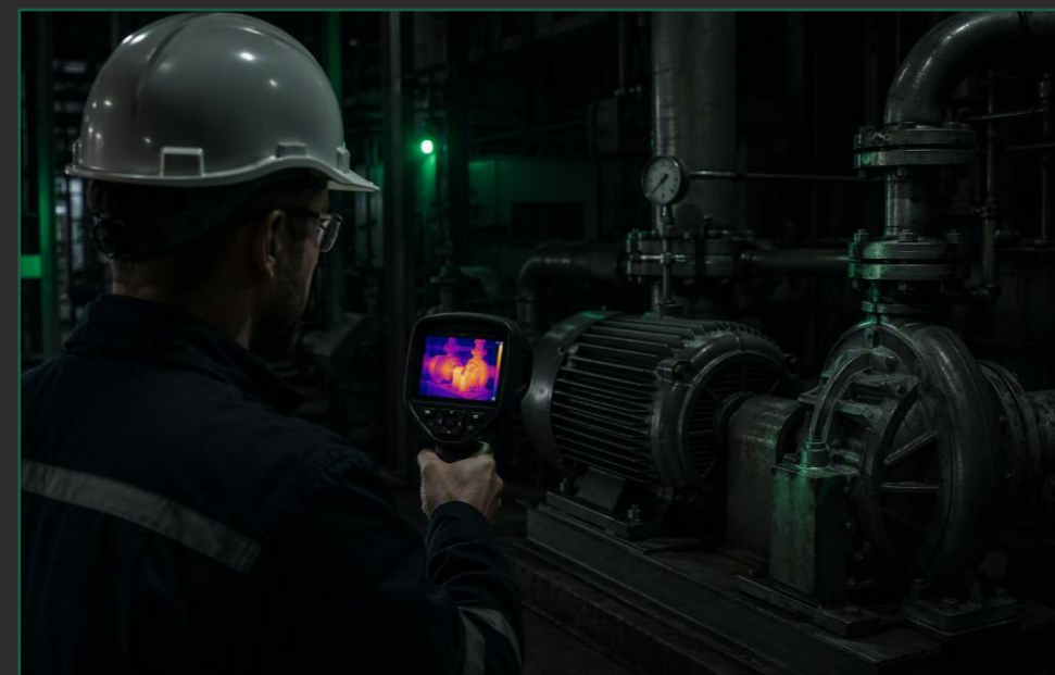
Термографический контроль электродвигателя — один из каналов раннего обнаружения дефектов. Иллюстрация: AI.
